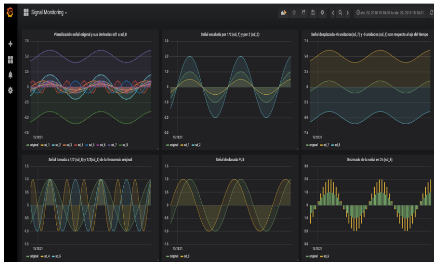
Fig. 6. Visualización de una señal senoidal utilizando el componente de QuantumLeap de FIWARE.
